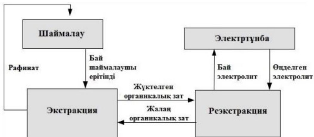
1 - сурет – Мысты гидрометаллургиялық технологиямен бөліп алу сұлбасы
